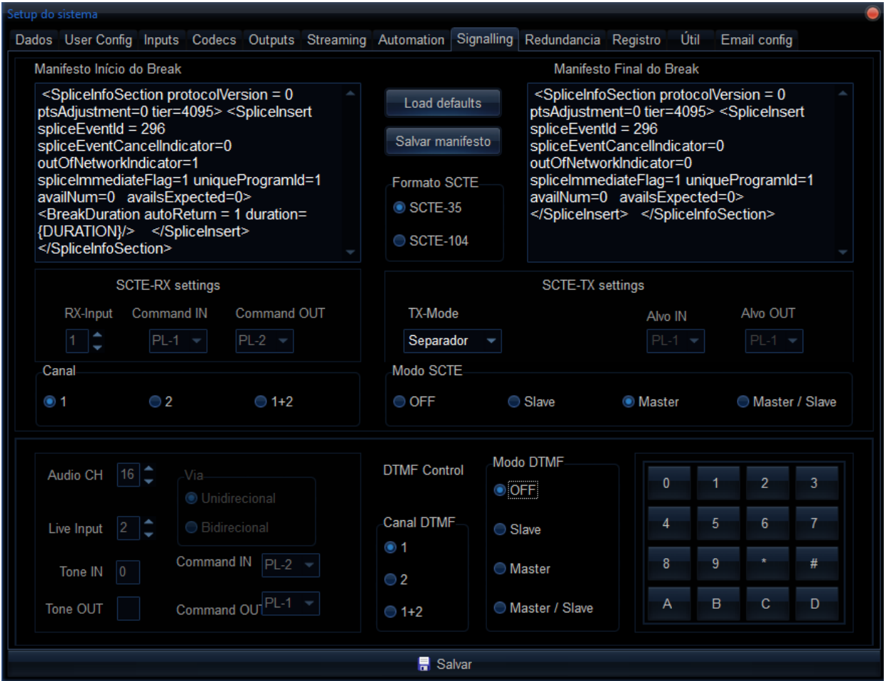
Figura - Sinalização SCTE-35/SCTE-104 e controle DTMF.
